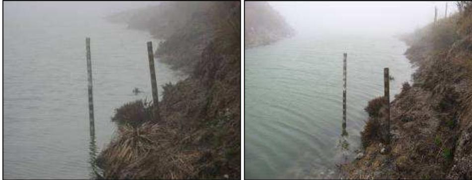
**Figura 2.3.23.** Comparación de nivel del agua de la Laguna Verde de Azufral, con medidores artesanales. Izquierda) imagen tomada el 24 de julio de 2010 y Derecha) imagen tomada el 5 de agosto de 2010.
