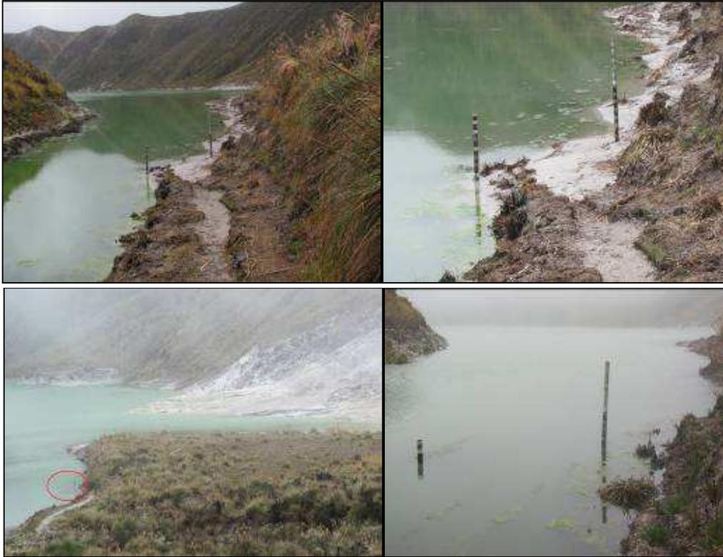
**Figura 2.3.39.** Comparación de nivel del agua de la Laguna Verde de Azufral, con medidores artesanales (sector norte). Arriba: Imágenes capturadas el 22 de octubre de 2010. Abajo: Imágenes capturadas el 13 de diciembre de 2010.
