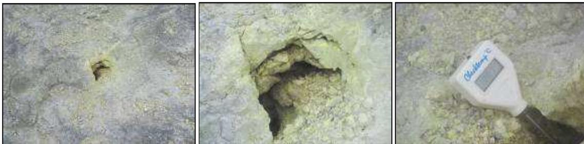
**Figura 2.3.37.** Imagen de una de las fumarolas del volcán Azufral, la cual registró una temperatura de 188,7 °C. Medida Realizada el 22 de octubre de 2010.
